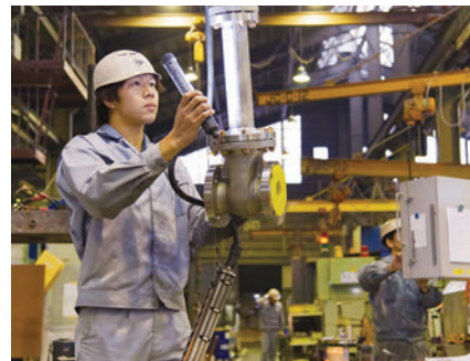
バルブの外観検査
