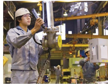
バルブの外観検査
