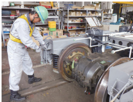
ボギー台車整備
